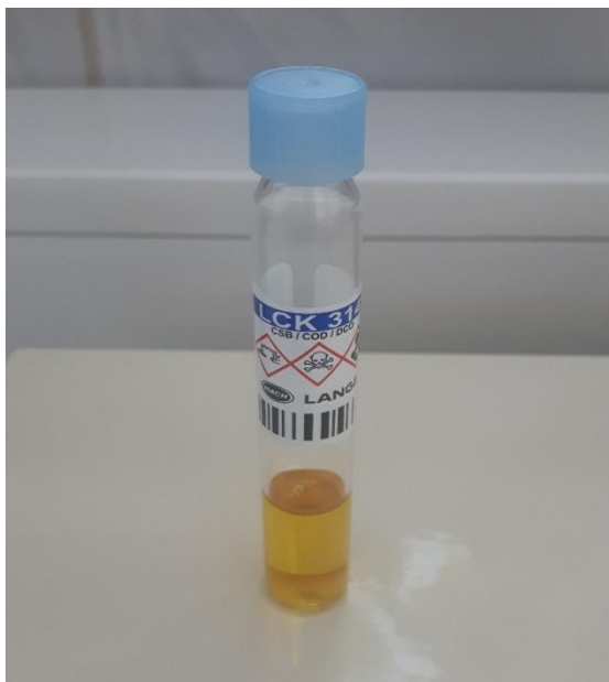
Slika 3.6: Kiveta Hach Lange LCK 314 [19]
