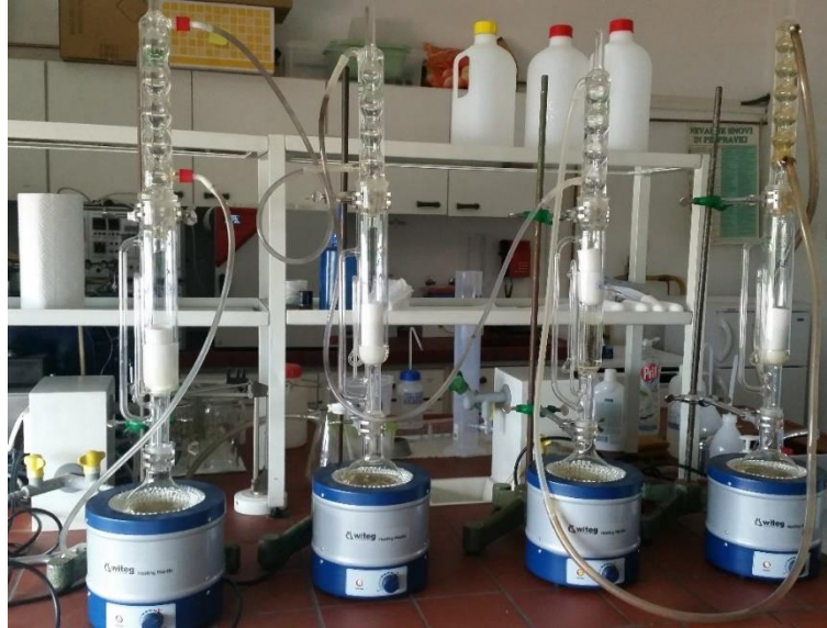
Slika 2-1: Sestavljena aparatura za ekstrakcijo z etanolom
