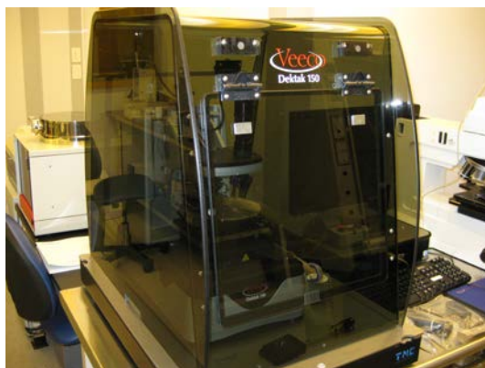
Slika 26: Profilometer podjetja Veeco (vir: Google slikovno iskanje).
