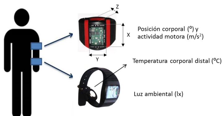
Figura 5. Dispositivo multicanal Kronowise® (Cronolab, Universidad de Murcia).
