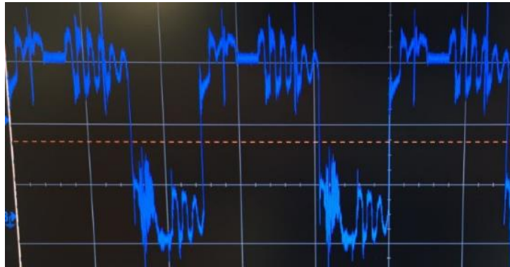
Imagen 59 | Tensión de salida de la placa de Arduino a 100 KHz. Pin 9.
