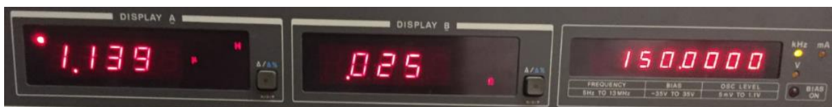
Imagen 45 | Analizador de impedancia 4192A. Inductancia de la bobina fabricada en el laboratorio a una frecuencia 150 KHz.
