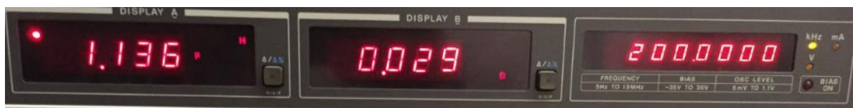
Imagen 46 | Analizador de impedancia 4192A. Inductancia de la bobina fabricada en el laboratorio a una frecuencia 200 KHz.
