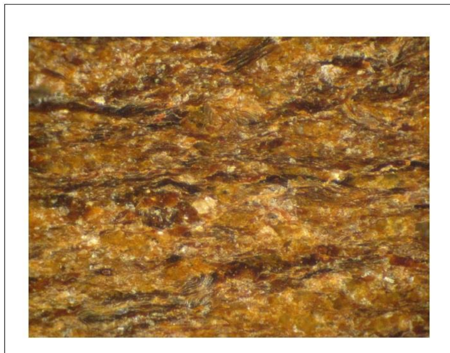
Fig. 9. Micrografía, con luz polarizada. En color oscuro se distingue la goetita y, en tonos, amarillos, la goetita hidratada o limonita.
