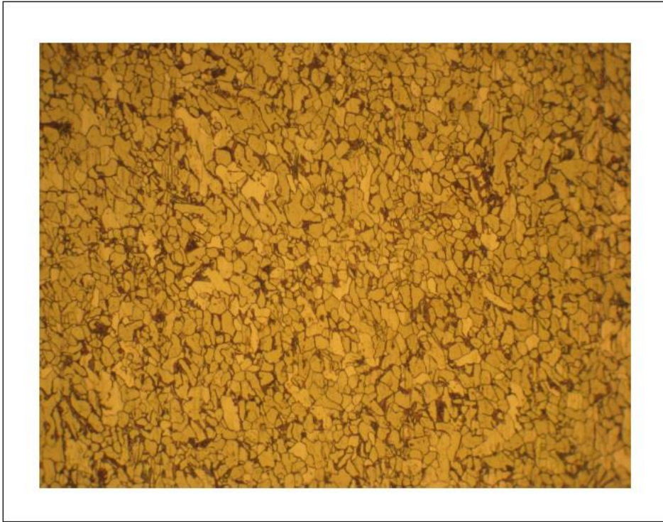
Fig. 27. Micrografía que muestra la microestructura del acero de la herradura. Se trata de un acero muy suave, hipoeutectoide de un 0'15% de carbono en masa, aproximadamente; de grano fino y muy homogéneo.
