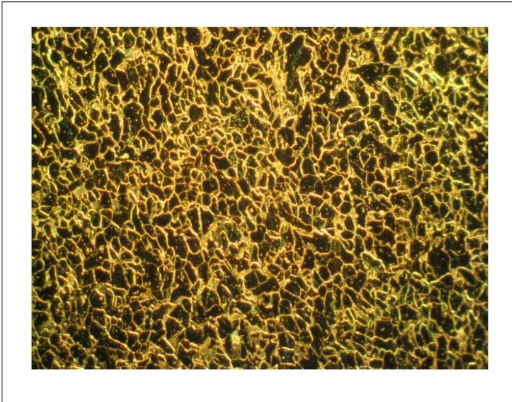
Fig. 29. Micrografía obtenida en campo oscuro en la que se aprecia, en tono oscuro, los cristales de ferrita y, en tono claro, los límites de grano. Esta imagen muestra, además, la homogeneidad del conjunto cristalino de la microestructura del acero.
