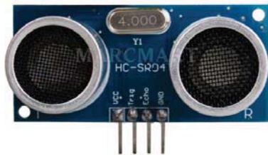
Figura 3. Sensor ultrasonidos HC-SR04
