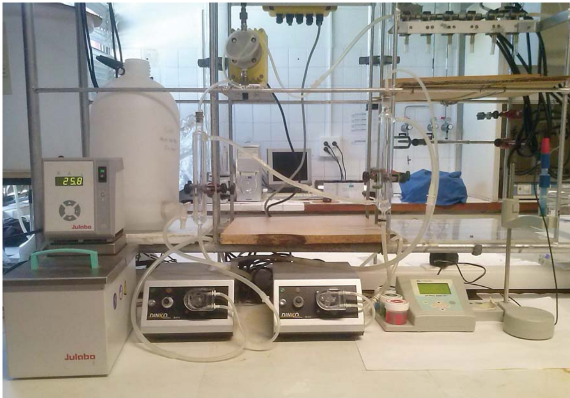
Figura 3.1. Dispositivo experimental utilizado en los ensayos de biosorción
