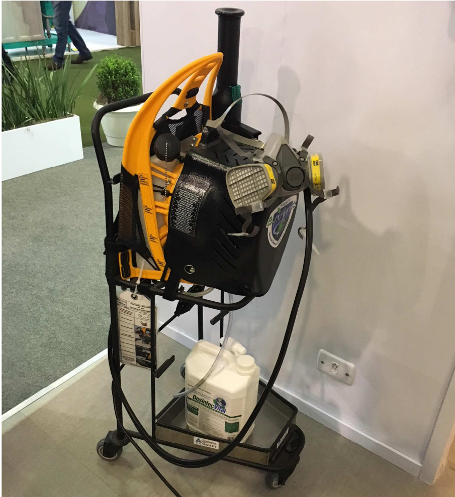
Figura 55 - Equipamentos utilizados para a realização da desinfecção do ambiente por pulverização de desinfetante. Fonte: A autora.
