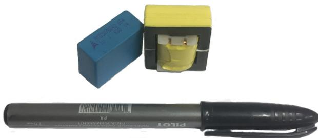
Figura 6.17 – Componentes empregados no filtro de saída do conversor proposto
