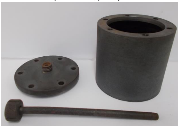
Figura 10 – Reator com tampa e conector, para a pirólise.
