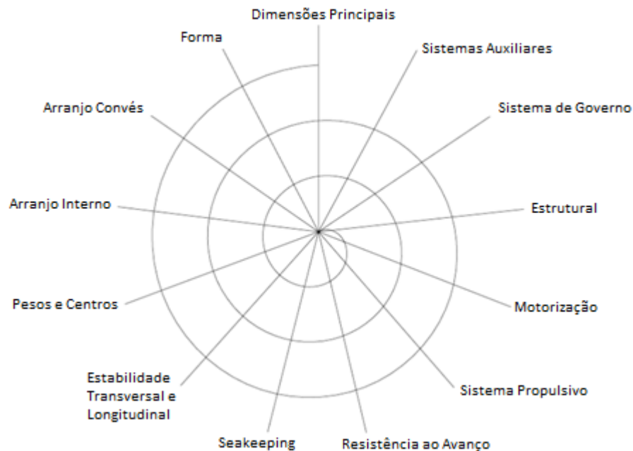
Figura 5 – Espiral de Evans para uma embarcação de pesca.
