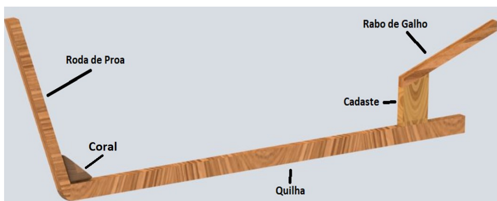
Figura 20 – Estrutura inicial onde as cavernas são encaixadas.
