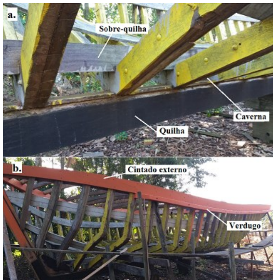
Figura 47 – Peças estruturais em um barco de madeira.
