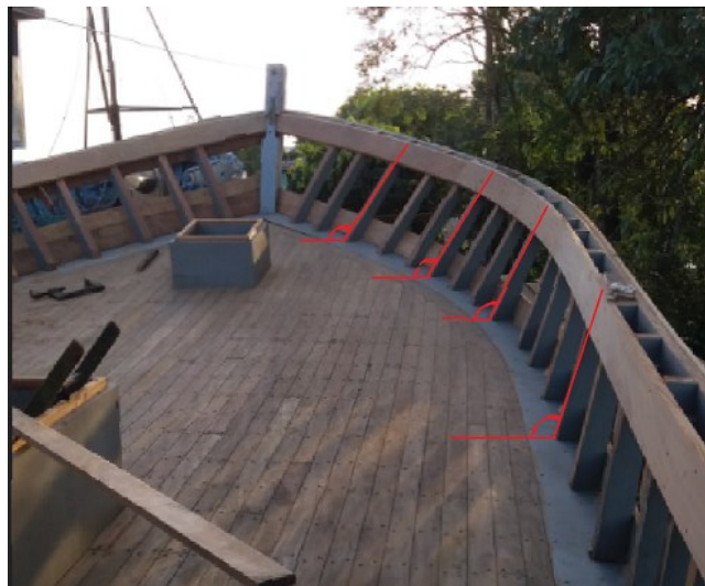
Figura 45 – Cordeamento da borda falsa.
