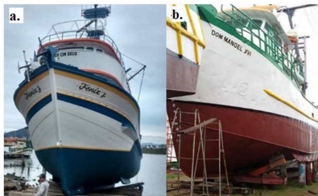
Figura 40 – Casco de madeira (a) e aço (b).
