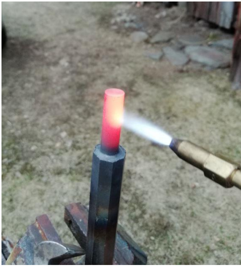
Kuva 5. Karapään lämmitys punahehkuun.
