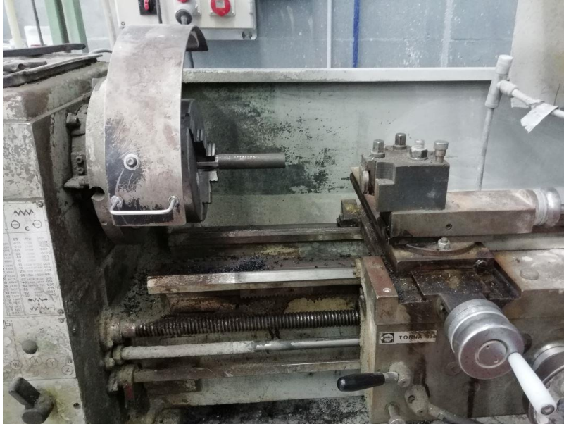
Kuva 2. Kappale kiinnitettynä sorvin istukkaan.
