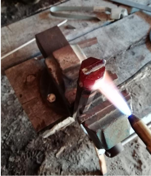
Kuva 4. Lämmittäminen juotoslämpötilaan happi-asetyleeniliekillä.
