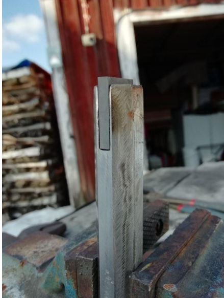
Kuva 3. Runkoon tehty hahlo kovametallipalalle.
