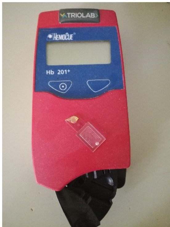
Kuva 5. Hemoglobiinin mittauksessa käytetty pikamittari ja mittarin päällä kyvetti, johon verinäyte imeytyi. (Alanko 2018)
