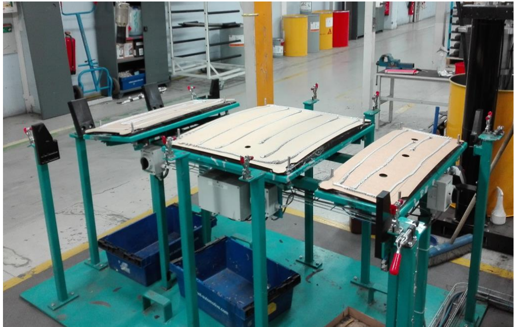
Kuva 4. Kuvassa robottisolua edeltävä Mercedes-Benz GLC:n pahvien liimauspöytä
