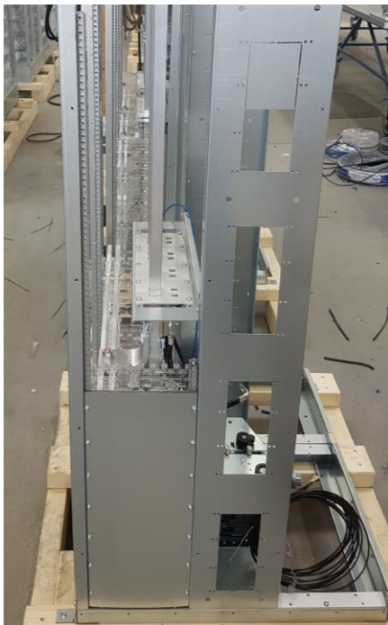
KUVA 15. Kojetilan ja kiskotilan osastointia
