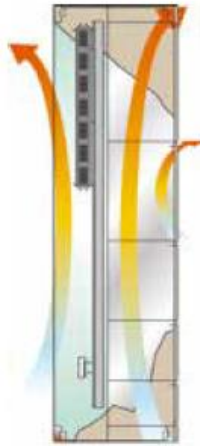
KUVA 7. Jäähdytys toteutettu luonnollisella ilmankierrolla (UTU 2018a)
