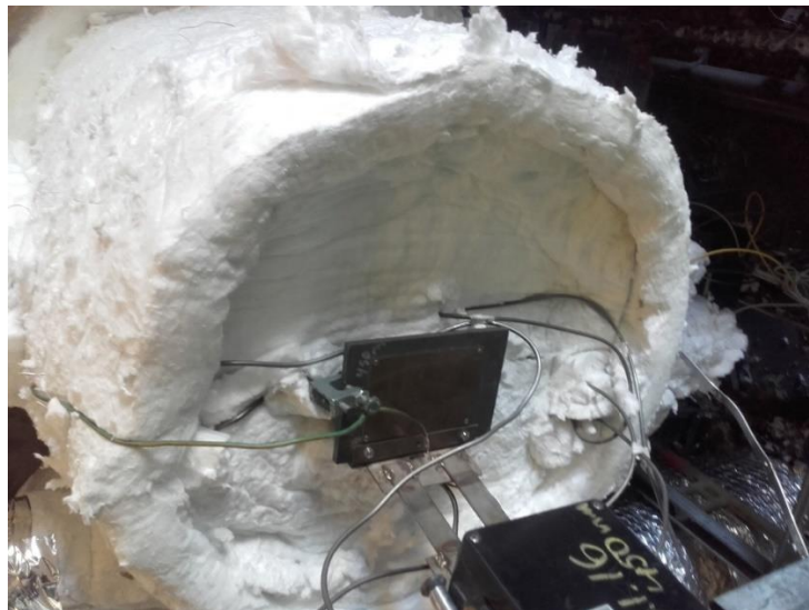
Kuva 8. Toimiva keraamivillaeristys kenttäinstrumentissa.
