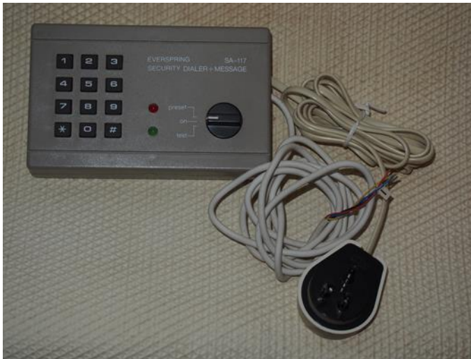
Kuva 4. Robottipuhelin siihen liittyvine johdotuksineen.
