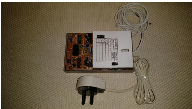
Kuva 5. Robottipuhelin avattuna. Alhaalla keskellä mikrofoni viestien nauhoittamista varten.
