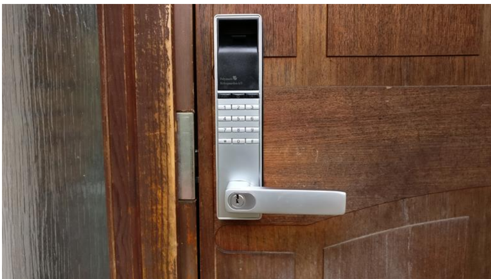
Kuva 16. Birkegaarden sormenjälkilukko asennettuna omakotitalon ulko-oveen.
