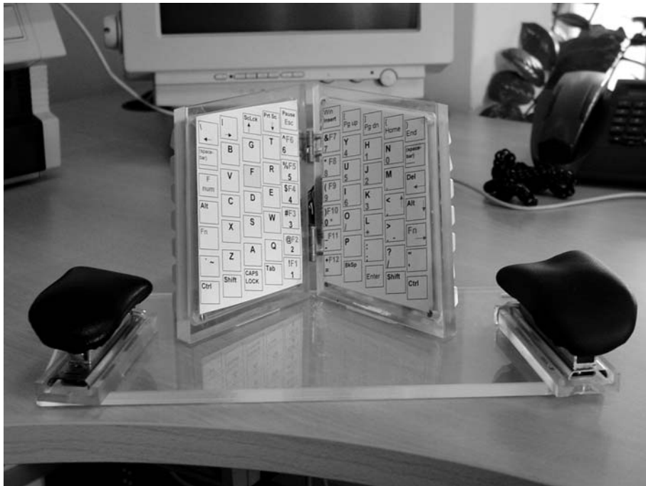
Figuur 7. Het verticale Yogitype toetsenbord, gezien vanuit de positie van de gebruiker. De gebruiker typt, met de polsen op de steunen en de handen in verticale positie, op de toetsen aan de achterkant van de twee rechtopstaande toetsenbordhelften, terwijl aan de voorkant de identiteit van de toetsen te zien is.
