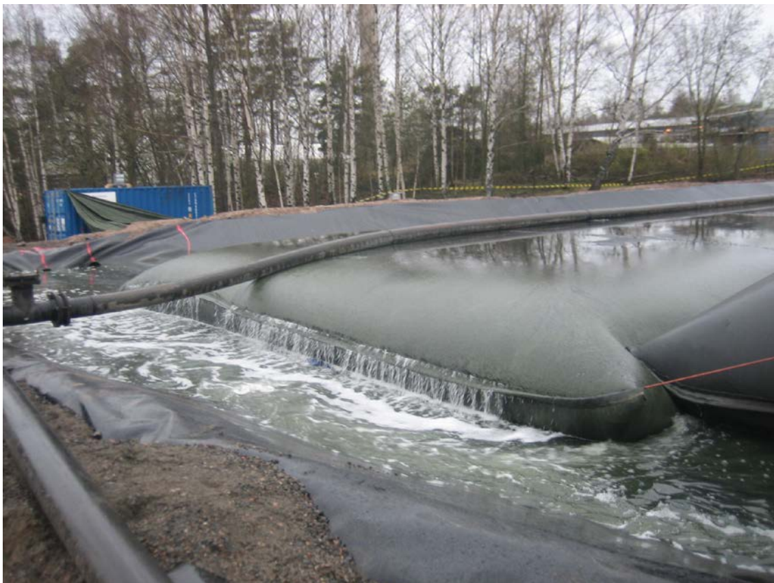
KUVA 6. TenCate Geotube® ulkokäytössä (Sito Oy:n materiaali, ystävällisesti heidän luvullaan)
