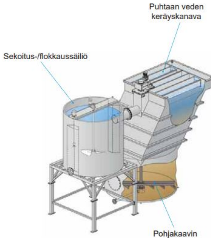
KUVA 5. Lamella-erottelija sekoitussäiliöllä ja pohjakaapimella (HYXO Oy:n materiaali, ystävällisesti heidän luvallaan)
