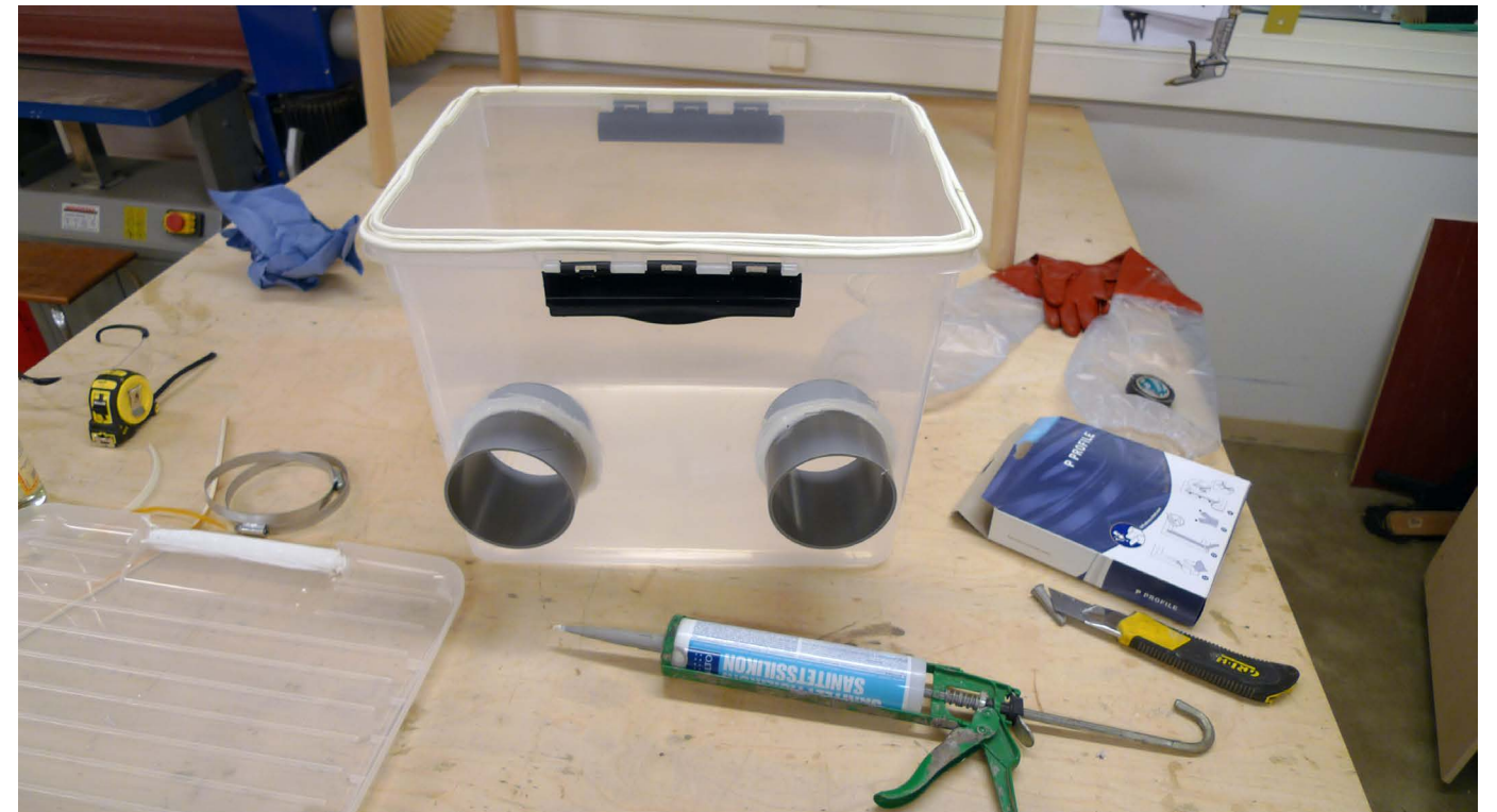
Kuva 24. Putkien tiivistys silikonilla, jonka jälkeen hanskat kiinnitetään letkukiristimillä putken päihin.
