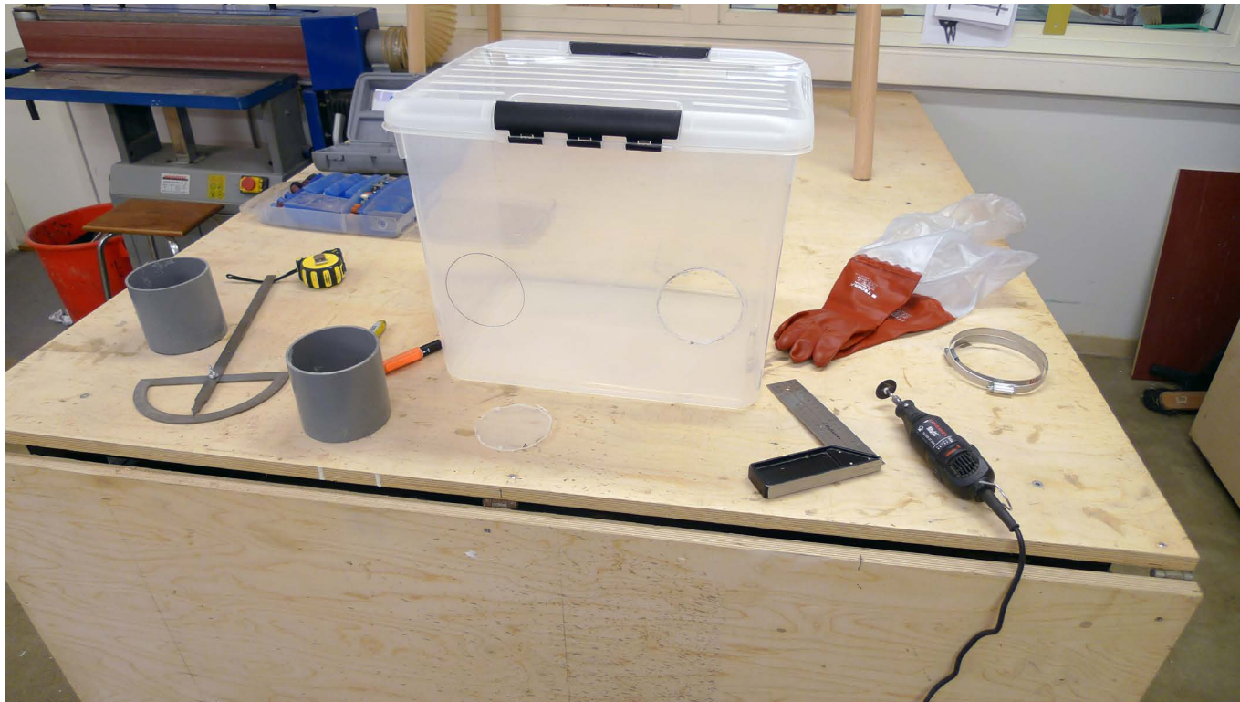
Kuva 21. Ensimmäinen vaihe oli tehdä reiät laatikkoon putkia varten.
