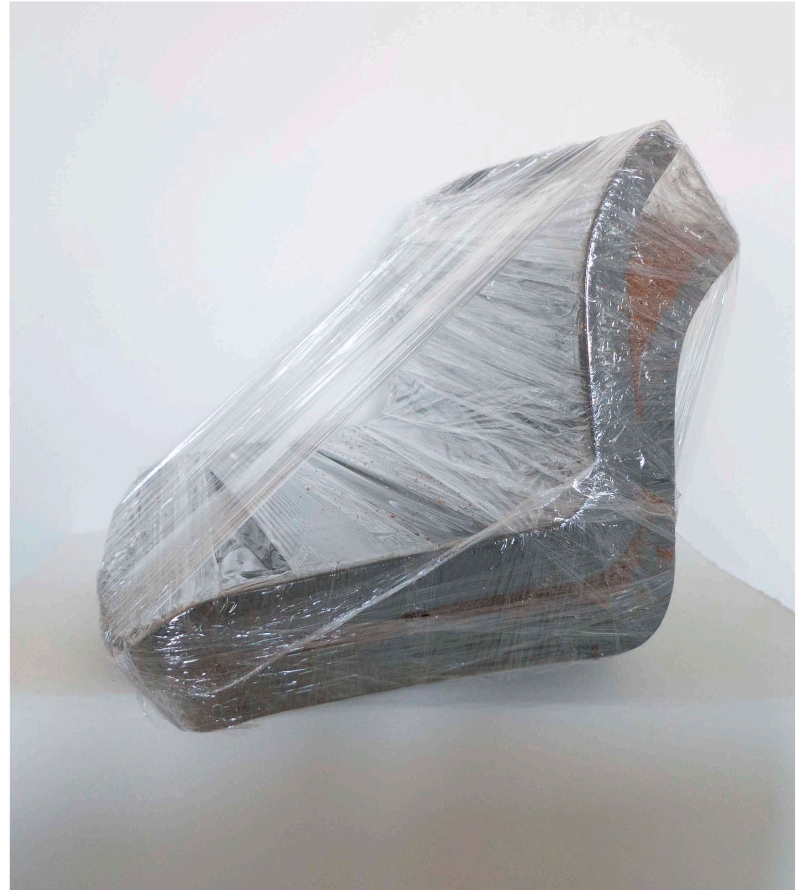
Kuva 56. Tuolien väli täytettynä esikasvatetulla olkipellettimassalla.
