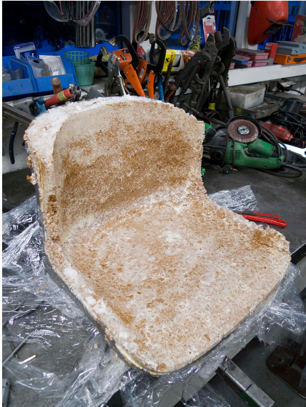
Kuva 57. Kymmenen päivän jälkeen muotti avattuna, ennen kuivatusta.
