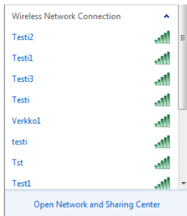
Kuva 21. Käyttäjän kannettavan tietokoneen näkymä verkoista. Joukossa langattoman reitittimen mainostama oikea SSID ”Testi”.
