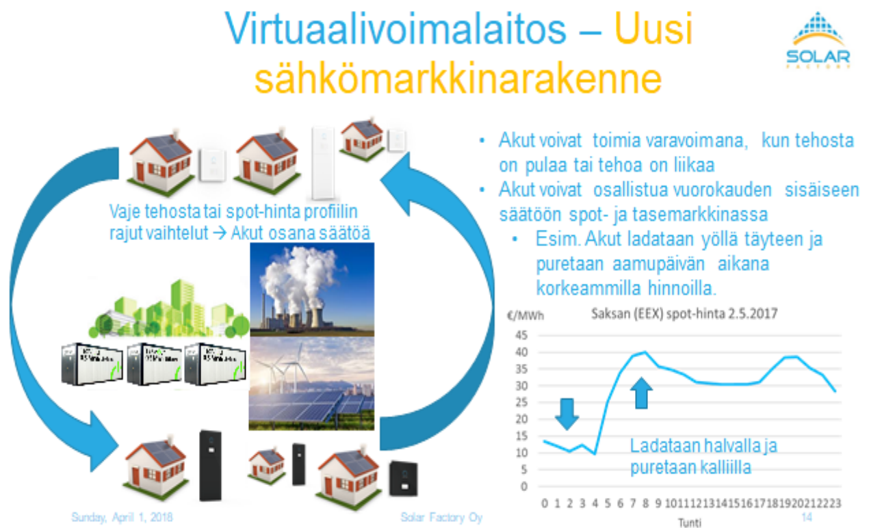
Kuva 2. Havainnekuva akkujen muodostamasta virtuaalivoimalaitoksesta (30).
