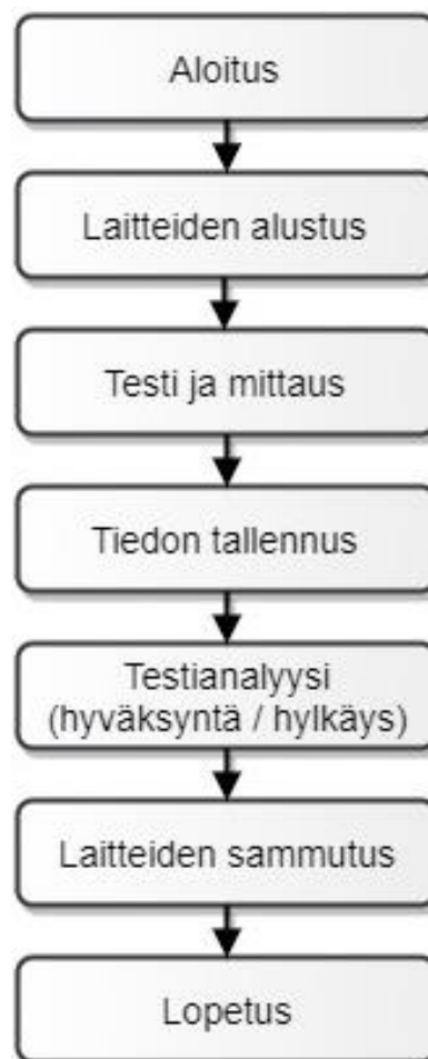
Kuva 3. Tyypillisen ATE-testauksen vaiheet yksinkertaistettuna.
