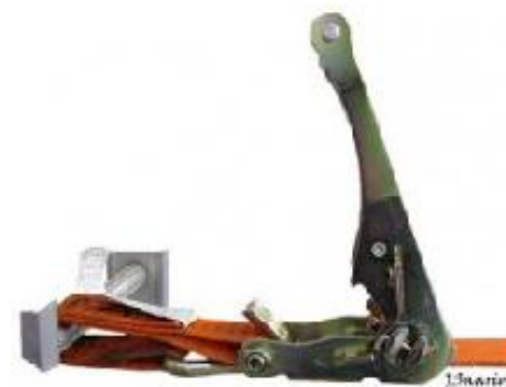
Kuva 5: Myös räikkä-osaan tehdään koukun avulla lenkki, joka kierretään kiinni- tyspisteen ympäri ja koukku kiinni- tetään räikkään.
