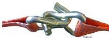
Kuva 8: Liina kierretään tukipisteen ympäri ja räikän koukut kiinnitetään yhteen.
