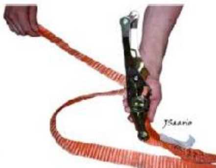
Kuva 9: Lopuksi liina vedetään räikän lävit- se.
