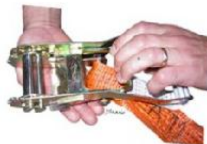
Kuva 11: Räikkä avataan vapauttamalla aluksi räikän lukitus.
