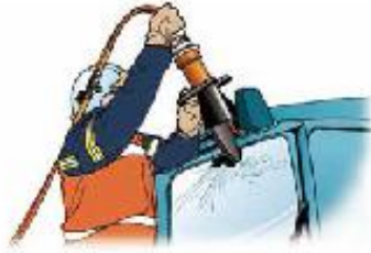
Vaihe 1: Tue ajoneuvo tuentaportailla ja -tangolla. Leikkaa A-pilari poikki
