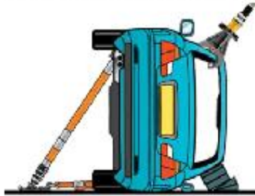
Vaihe 3: Leikkaa B- ja C-pilarit poikki.
