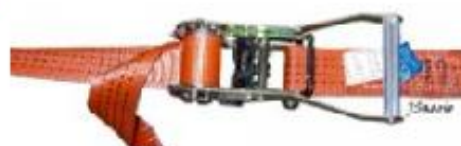
Kuva 16: Lopuksi räikkä suljetaan ja varmistetaan, ettei ylimääräisestä liinasta aiheudu haittaa.
