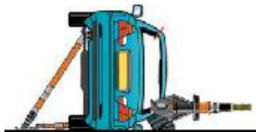
Vaihe 4: Tee katon alareunassa osittainen leikkaus joka toimii saranana, kun katto käännetään alas. Vaihtoehtoisesti katto voidaan leikata kokonaan irti.
