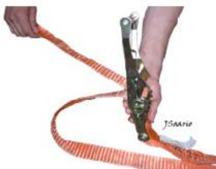
Kuva 14: Vedä liinasta "löysät pois".
