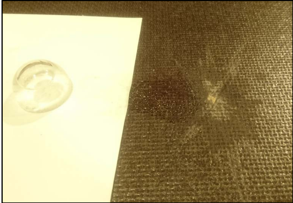
KUVA 13. Pinnan kovuuden testaaminen raaputtamalla. (Lappalainen 2018)
