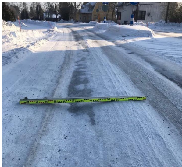
Figur 2. Jämnheten på isbeläggningen kan mätas med en lång linjal.
