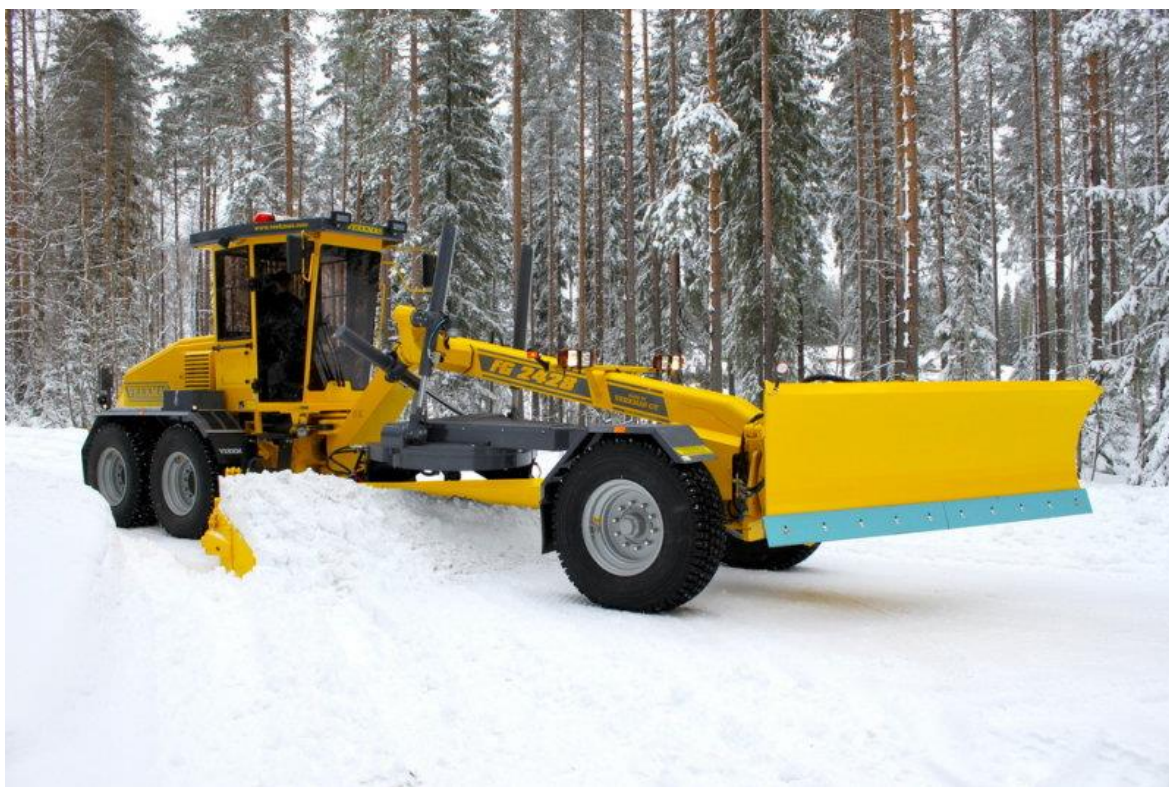
Figur 8. Väghyveln är ett bra men kostsamt redskap för isröjning (Veekmas Oy, 2018).
