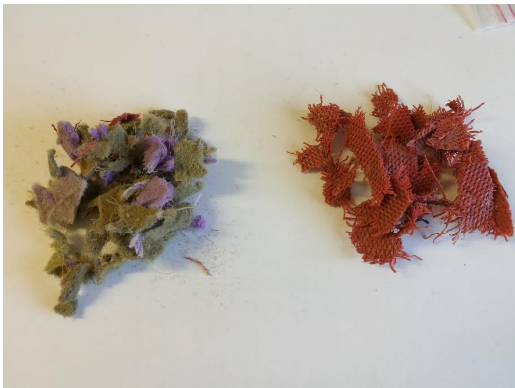
KUVA 6. Testierä, murskattua paperikonekudosta. Vasemmalla puristinhuopa ja oikealla kuivaviiramurske. © Pilvi Konttila 2017
