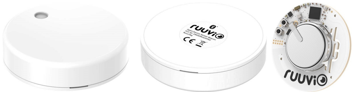
Kuva 6. Ruuvitagin kotelo päältä ja alta sekä piirilevy ja paristo. [24.]
