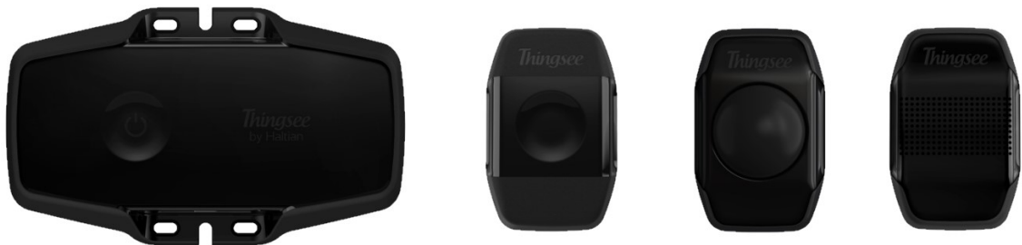
Kuva 5. Thingseen järjestelmän osat: Gateway, Distance, Presence ja Pod 2. [23.]
