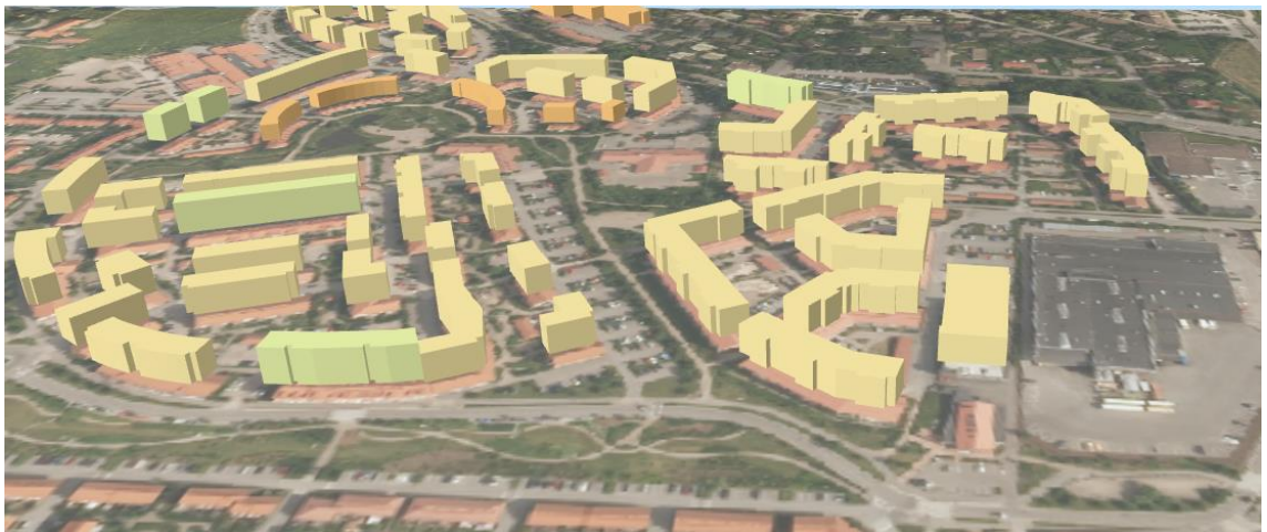
Kuvio 12. Rakennustietokannasta suodatettuja vähintään 3-kerroksisia rakennuksia sovitettuna ortokuvaan 3D-näkymässä
