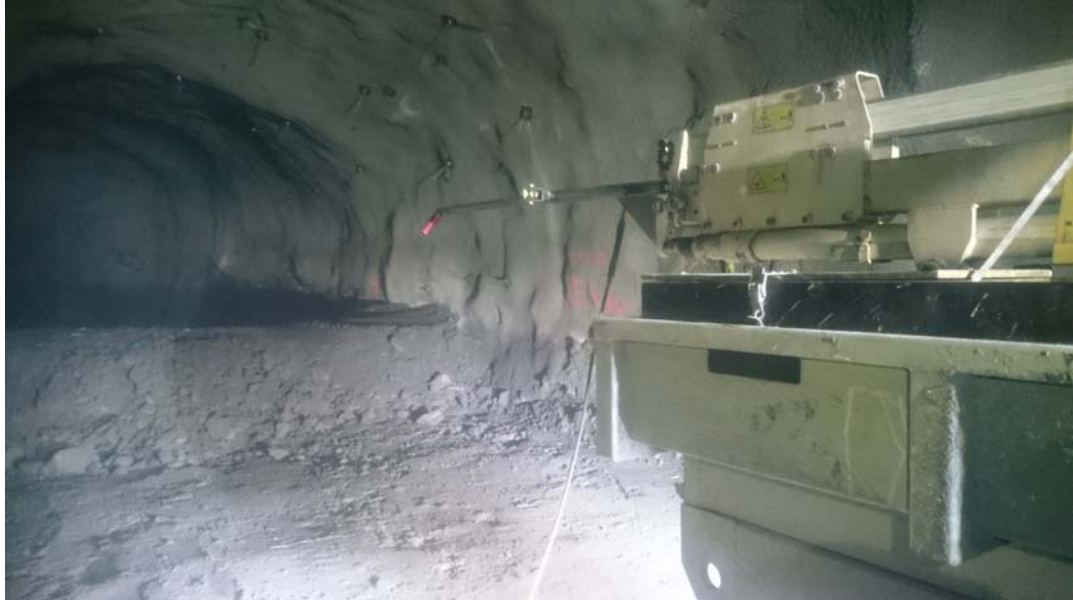
Kuvio 17. Multimec ja laserkeilain telineineen ja turvapankka
