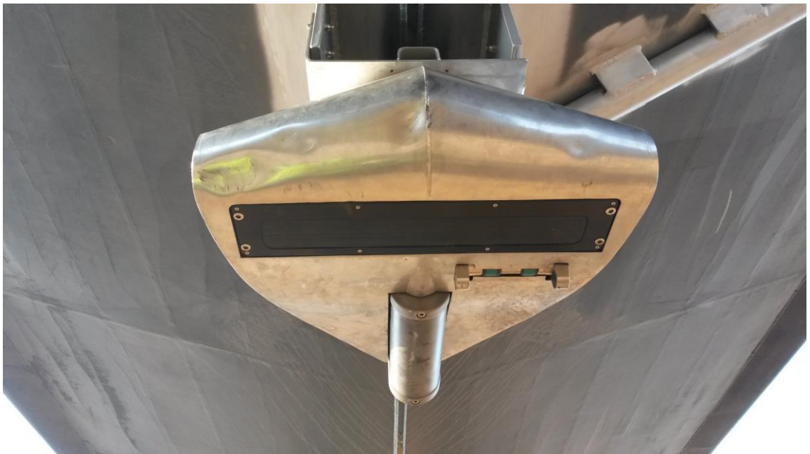
Kuva 4. Reson SeaBat 7125 SV2 -monikeilain asennettuna mittausvene Keilaan (31).
