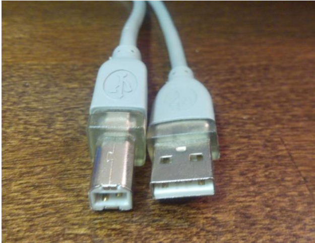
KUVA 7. Vasemmalla USB-B -liitin ja oikealla USB-A -liitin
