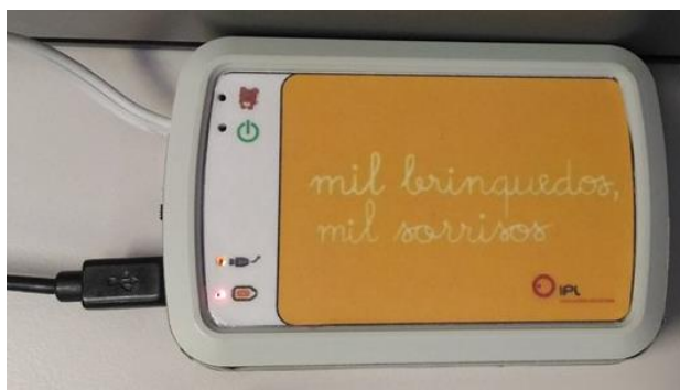
Figura 2 – Aspeto exterior do interruptor com fios.
