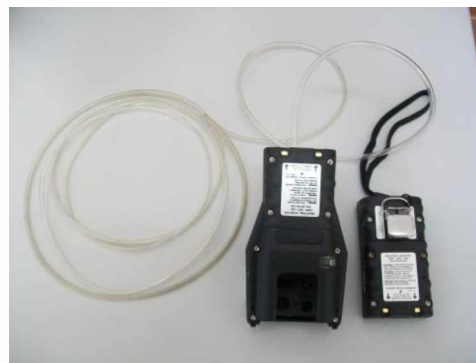
Detetor multigás com bomba de aspiração e sonda
