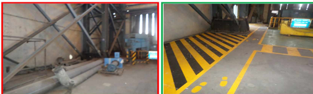
Figura 22 - Exemplo de melhoria 5s (separação e normalização)
