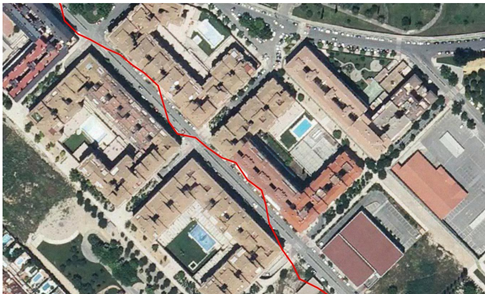
Figura II.2. Efecto multitrayectoria sobre una traza (Gil de la Vega, Ariza-López, & Mozas-Calvache, 2016).
