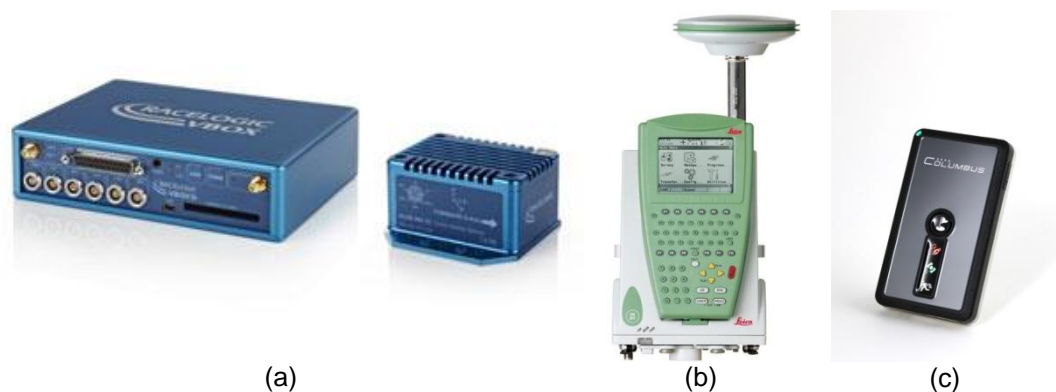
Figura III.1. Equipos GNSS utilizados en los levantamientos: (a) Racelogic Vbox, (b) Leica 1200, (c) Columbus V990.
