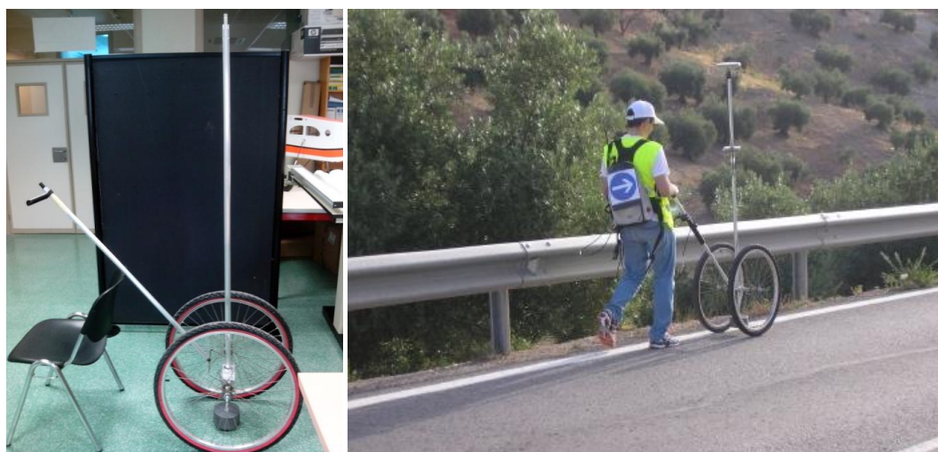
Figura III.10. Levantamiento con equipo GNSS montado sobre el “dispositivo autonivelado”.
