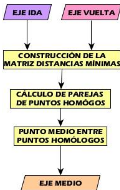
Figura III.28. Algoritmo de cálculo de eje medio basado en la distancia de Fréchet.
