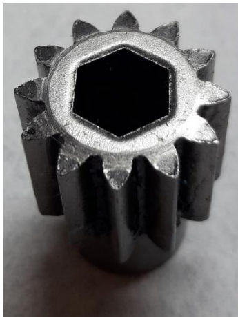
Figura 8.2.5. Primer engranaje de la caja reductora del cabrestante Runva EWX 9500-Q.
