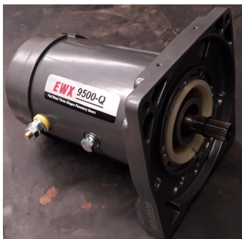
Figura 8.2.7. Motor del cabrestante Runva EWX 9500-Q.
