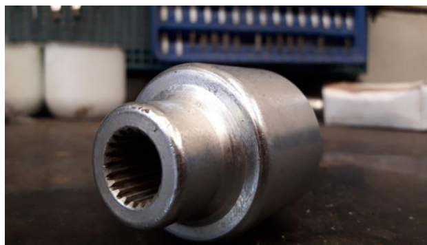
Figura 10.4.3. Pieza del sistema de frenado que une el mismo al eje de salida del motor.
