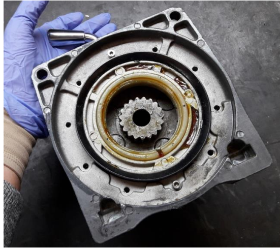
Figura 8.2.2. Entrada y salida de la caja reductora del cabrestante Runva EWX 9500-Q.
