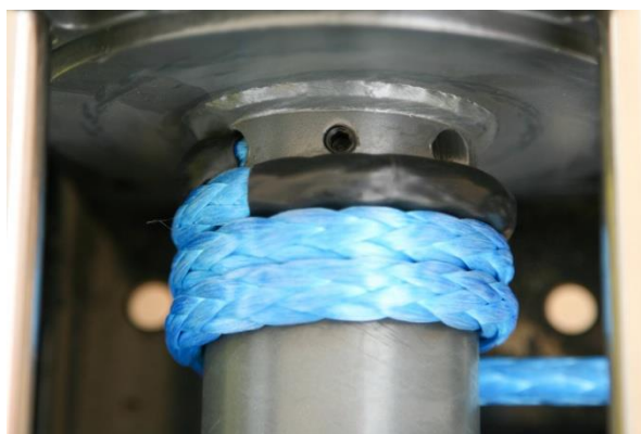
Figura 8.2.6. Anclaje del cable al tambor del cabrestante Runva EWX 9500-Q (imagen extraída de internet. Fuente: www.whichcar.com.au ).
