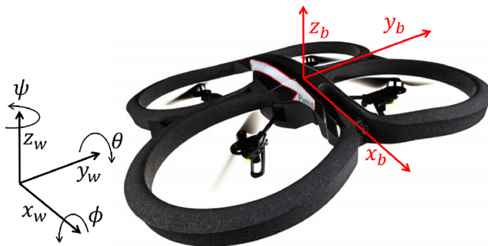
Figura 32: Ar.Drone en su versión 2.0 y sus correspondientes sistemas de referencia móvil asociado al helicóptero \{b\} , y el sistema de referencia inercial \{w\} .
