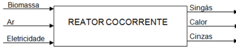
Figura 4-31: Esquema do balanço exergético para o sistema de tratamento proposto.
