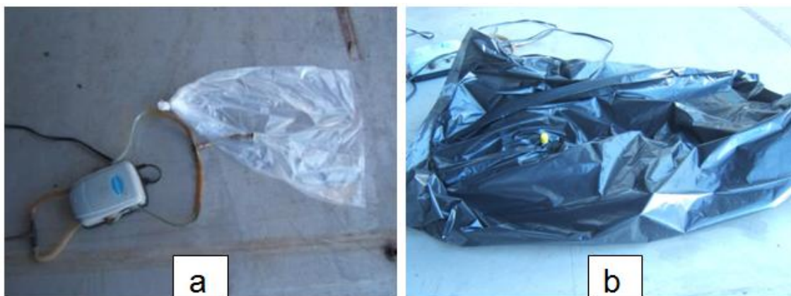
Figura 4-27: Balão plástico para coleta de gás (a), e envolto em plástico preto para evitar a incidência de luz (b).
