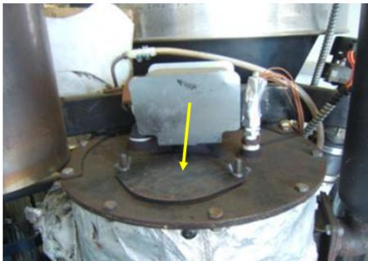
Figura 4-22: Topo de reator onde se observa a janela de inspeção e recarga.
