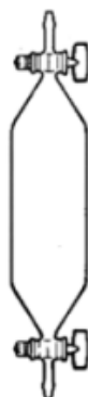
Figura 4-26: Desenho do tipo de ampola utilizada para a coleta do gás, com capacidade de 250 ml, utilizada para análise dos gases no laboratório de química da Arcelor Mittal.
