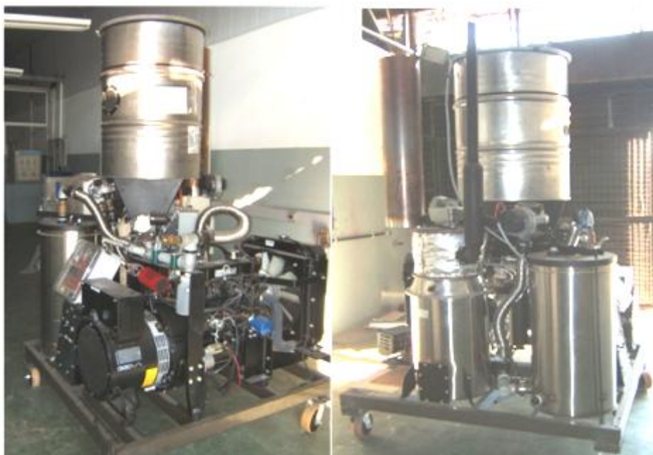
Figura 4-16: Gaseificador de biomassa ALL POWER PELLET GEK 20 KW.
