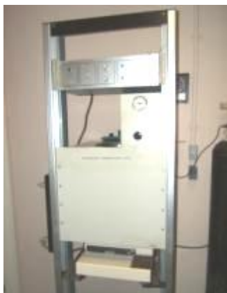
Figura 4-9: Calorímetro GCA usado na determinação do PCS.
