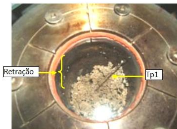
Figura 5-9: Topo do reator de bancada onde se observa o termopar Tp1 e a retração de volume ao final do processo de gaseificação.
