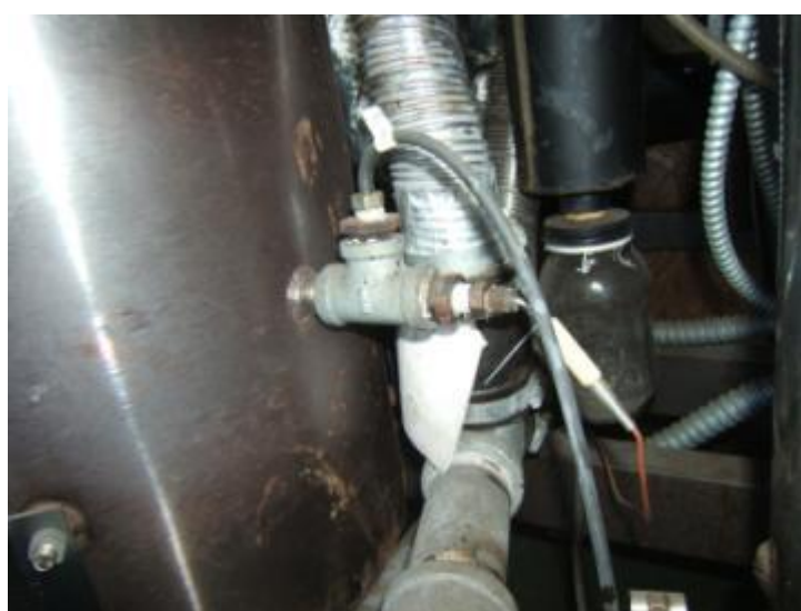
Figura 4-23: Ponto de tomada de pressão interna do gaseificador bem como da temperatura do gás logo após a sua saída da zona de oxidação.
