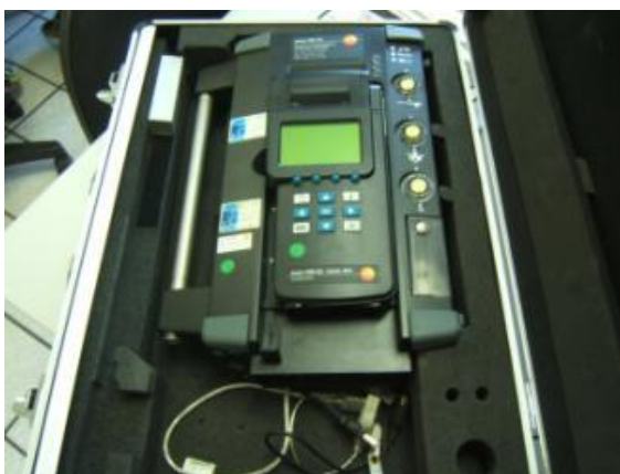
Figura 4-25: Analisador de gases, marca TESTO, modelo 454 M/XL.
