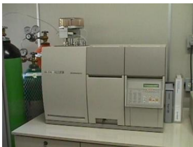
Figura 4-10: Equipamento para Análise Elementar - CE Instruments/EA 1110.
