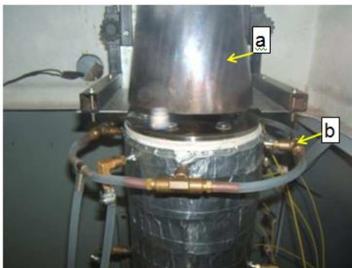
Figura 4-14: Parte superior do reator de bancada, onde se observa o cone de ignição (a) e os dutos de entrada de ar (b).
