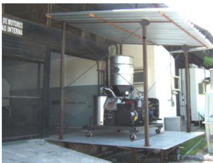
Figura 4-17: Plataforma para possibilitar o uso do gaseificador de biomassa fora do laboratório.
