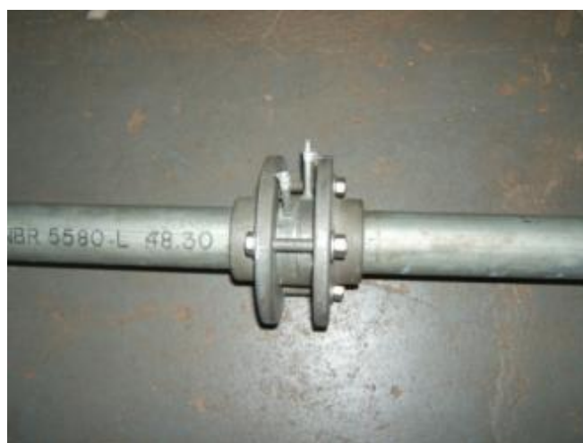
Figura 4-21: Sistema de medição da vazão de ar.
