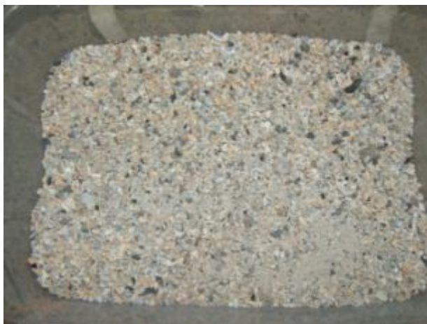
Figura 5-15: Aspecto das cinzas após sua retirada do gaseificador.
