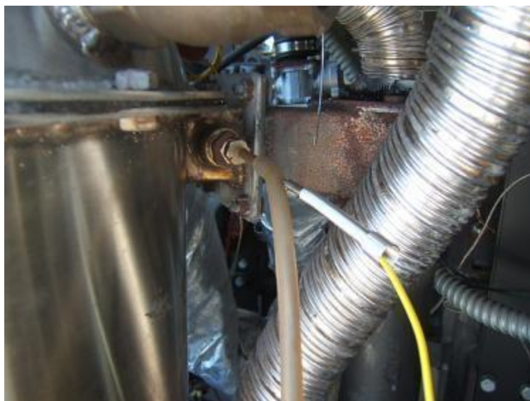
Figura 4-24: Ponto de coleta do gás e de sua temperatura na saída do reator.
