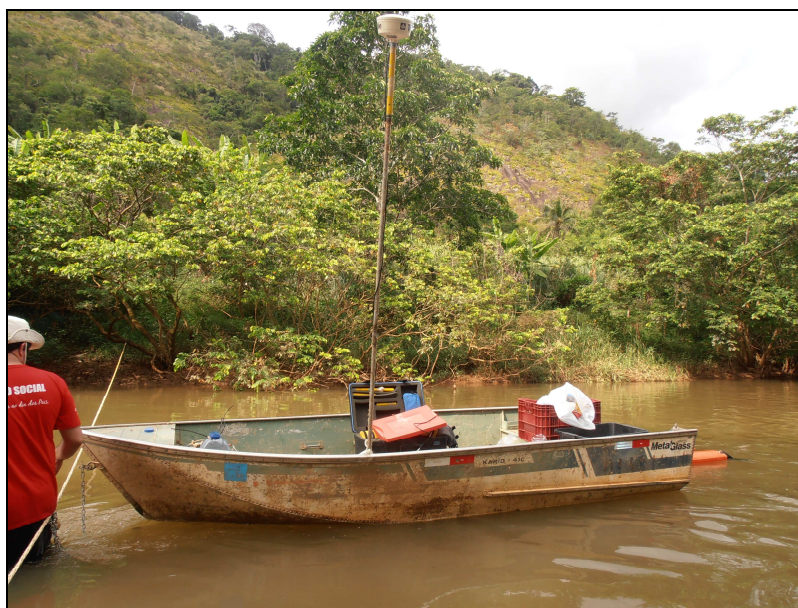
Figura 17: Posicionamento do DGPS e flutuador do ADCP em uma das campanhas realizadas
