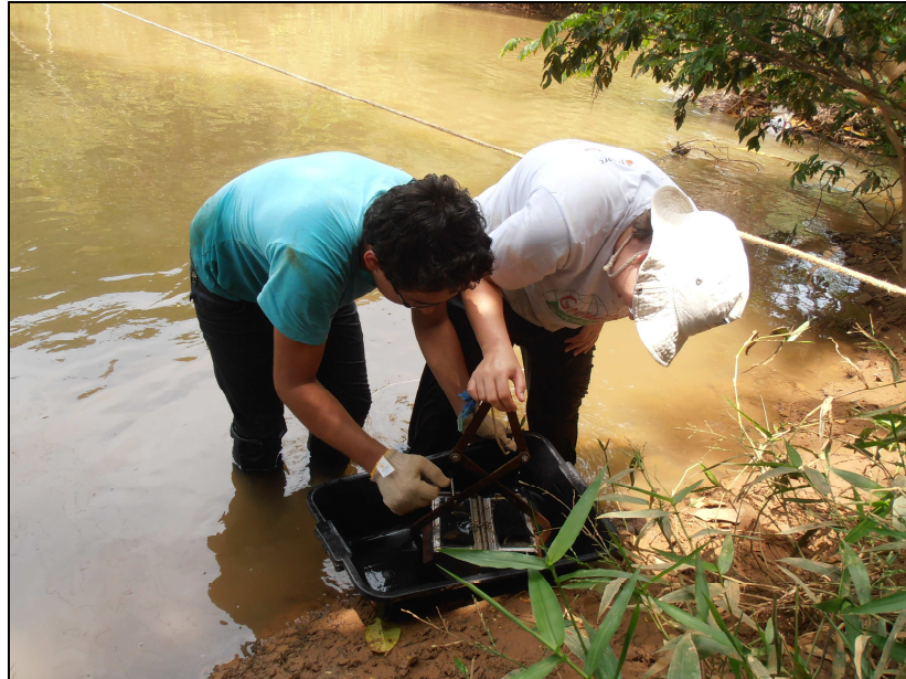
Figura 14: Detalhe da abertura da draga durante coleta de sedimentos de fundo na campanha do dia 04/01/2013.
