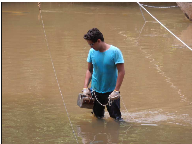
Figura 13: Utilização do amostrado tipo draga para coleta de sedimentos de fundo na campanha de 04/01/2013.
