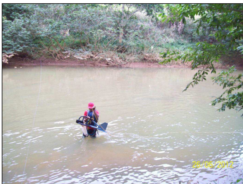
Figura 16: Utilização do amostrador Helley Smith durante a campanha do dia 26/06/2012.
