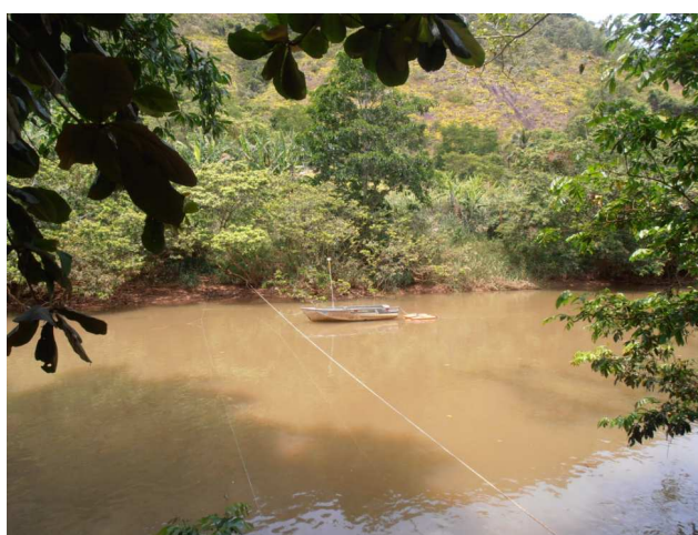
Figura 32: Barco com DGPS e flutuador do ADPC acoplados para a realização da tomada de dados de velocidade das partículas de fundo na campanha de 04/01/2013.
