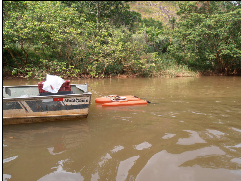
Figura 02: ADCP em uso durante campanha do dia 13/04/2013.
