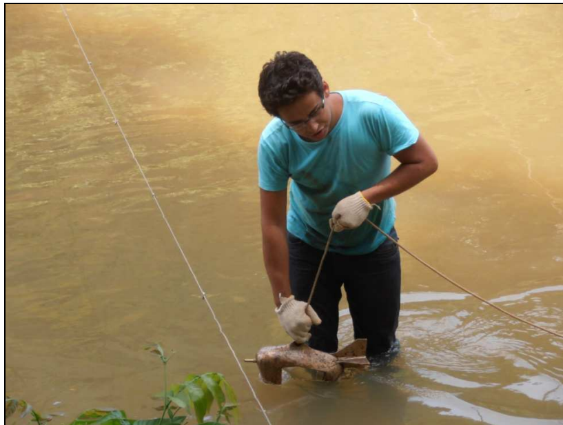
Figura 09: Utilização do amostrador USDH 59 para coleta de sedimentos em suspensão na campanha de 04/01/2013.
