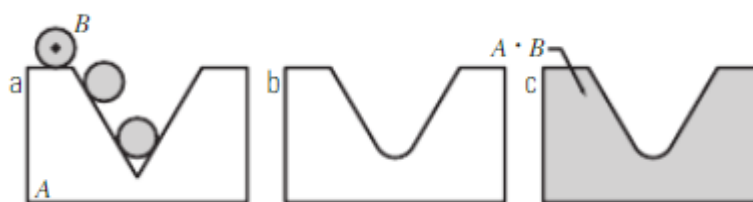
Figura 64 – Interpretação geométrica da operação de fechamento. (a) Elemento estruturante B “rolando” pela parte de fora da fronteira de A. (b) Fronteira do fechamento. (c) Resultado da operação de fechamento da imagem A.
