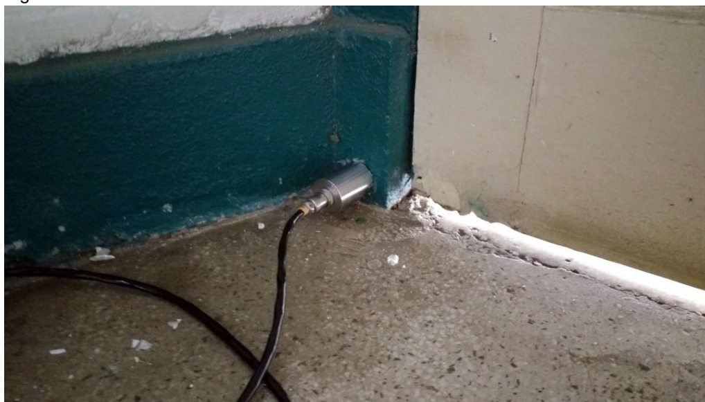
Figura 95 - Acelerômetro 01 fixado no Museu do Colono
