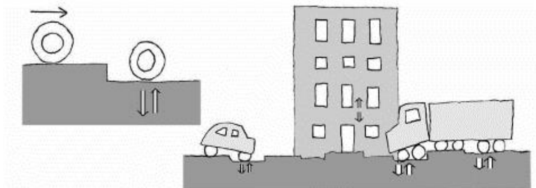
Figura 13 - Exemplo de vibração causada por tráfego com irregularidade na via
