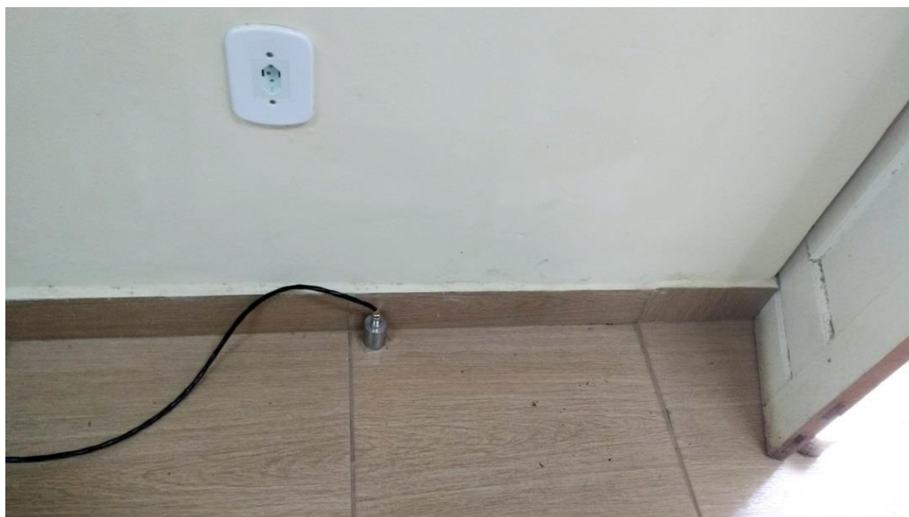
Figura 106 - Acelerômetro 02 fixado na Prefeitura Municipal de Santa Leopoldina
