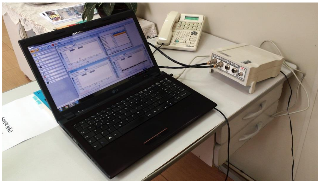
Figura 94 - Coletor e Analisador de Vibrações NK840 conectado ao computador
