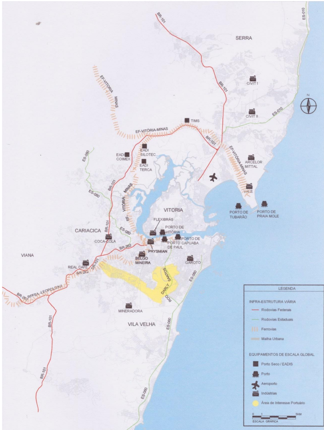
Figura 3 - Principais áreas industriais, portos e infraestrutura viária da Grande Vitória
