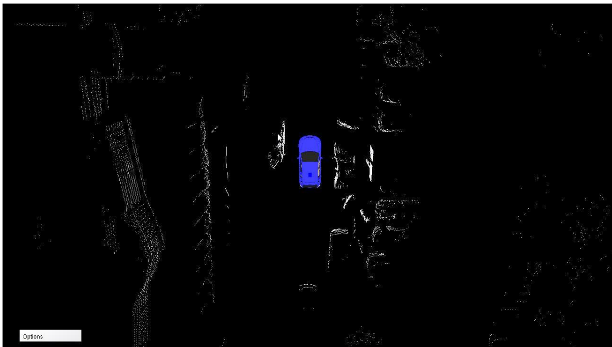
Figura 20: Exemplo de uma nuvem de pontos 3D após a execução do algoritmo adotado para remoção do plano do solo. Os pontos destacados em branco são associados aos objetos considerados obstáculos
