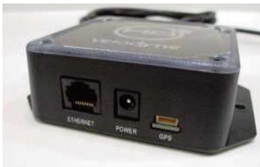
Figura 31: Conexões de dados do LIDAR HDL-32E
