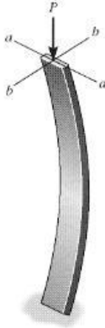
Figura 1 – Flambagem ocorrendo em uma barra de seção retangular. A flambagem ocorrerá em torno do eixo a-a devido ao menor momento de inércia. Fonte: Hibbeler, 2006.
