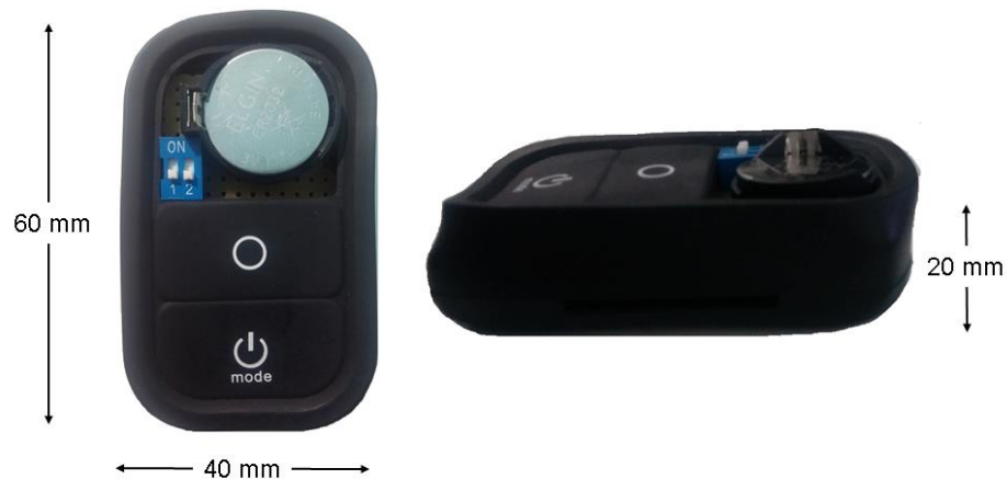
Figura 20 - Protótipo montado e suas dimensões.
