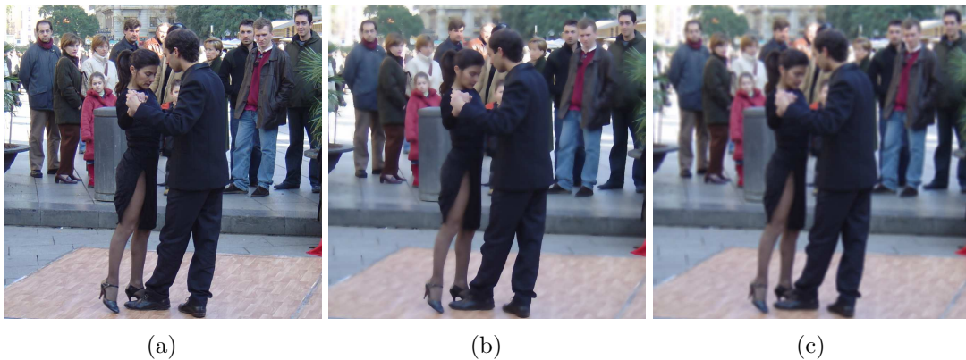
Figura 17 – Exemplos de filtragem usando o filtro bilateral, com tamanho da máscara S = 11 \times 11 pixels. (a) - Imagem original, (b) - \sigma_s = 200 e \sigma_r = 0,2 , (c) - \sigma_s = 10 e \sigma_r = 1 .
