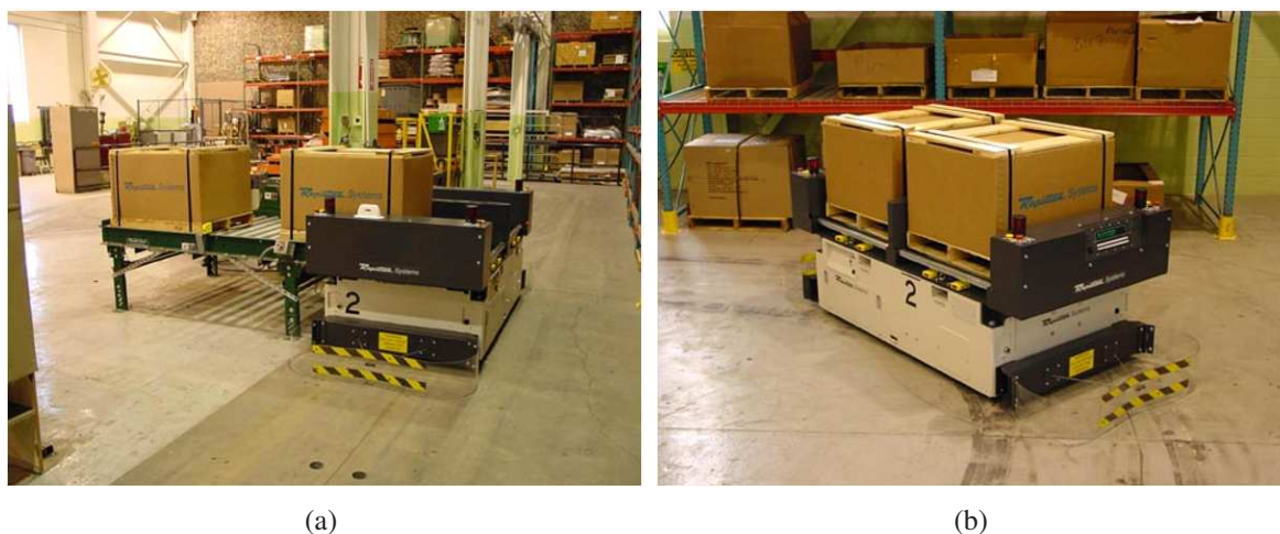
Figura 1.7: AGV sendo utilizado para coleta (a) e transporte (b) de produtos.
