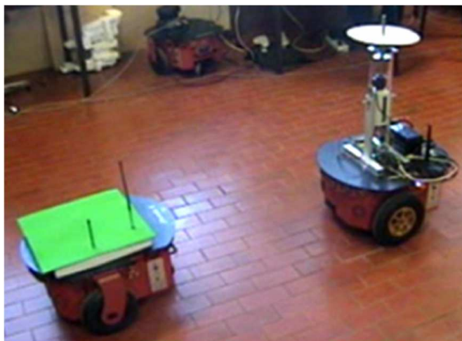
Figura 2.3: Movimento coordenado de dois robôs móveis utilizando um sistema de visão omnidirecional.
