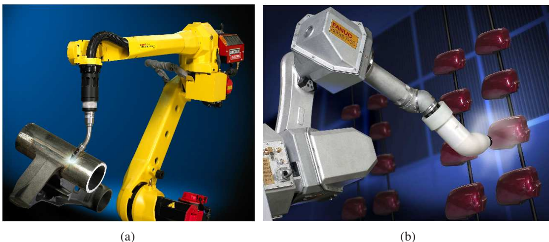
Figura 1.3: Imagens ilustrativas de manipuladores industriais realizando solda a ponto em uma peça metálica (a) e pintura a spray em retrovisores de automóveis (b).
