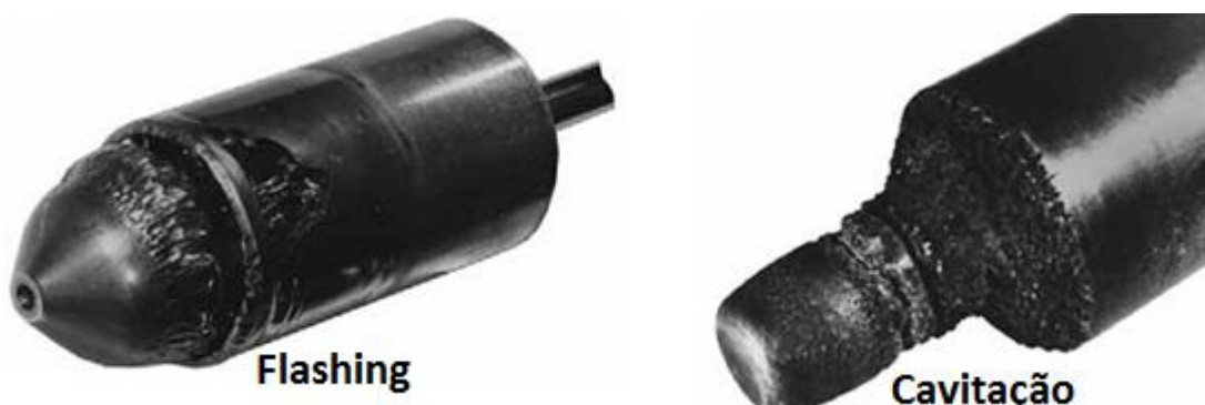
Figura 2 – Danos típicos causados por flashing e cavitação.
